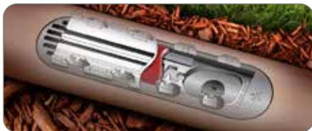
La tubazione in polietilene flessibile prevede, da fabbrica, dei gocciolatori autocompensanti installati ogni 33 centimetri. La portata di ciascun gocciolatore installato è di 2,3 litri all'ora quando la pressione di alimentazione è compresa tra 0,58 e 4,14 bar.
