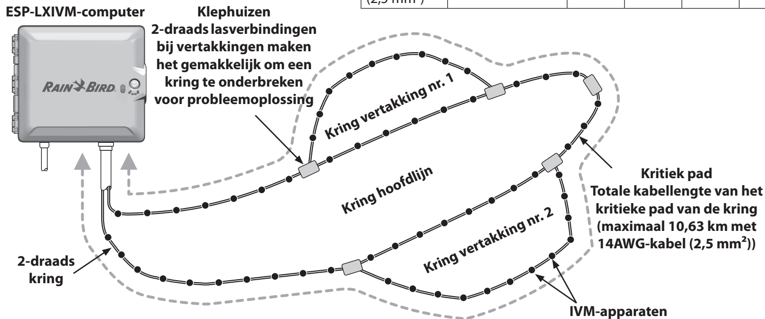
Ontwerp 2-draads kringpatroon met IVM-apparaten en kleppen
