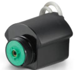
Tous les arroseurs électriques à rotor Rain Bird pour terrains de golf sont équipés d'une électrovanne GBS25 robuste. Grâce à un plongeur captif, une protection contre les surtensions jusqu'à 25 kV et un dispositif de filtration intégré qui fournit une protection supplémentaire contre les débris, cette électrovanne élimine les corvées de maintenance les plus courantes, requises sur les arroseurs concurrents.
