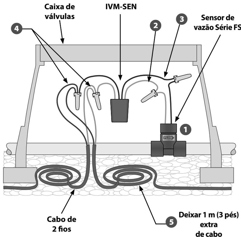
Ligação típica do sensor de vazão IVM-SEN
