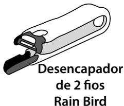
**NOTA:** para evitar danos aos fios, ferramentas como canivetes suíços, canivetes, estiletos ou desencapadores Romex não devem ser usadas para descascar os fios.
