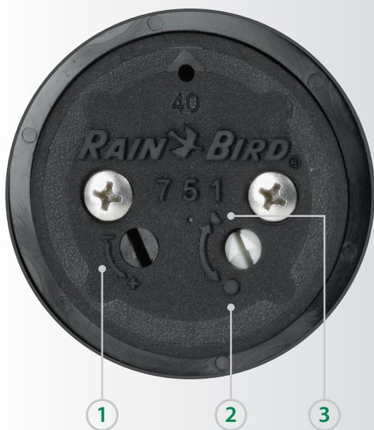
Quer você esteja restaurando para cultivo ou apenas tentando obter o máximo de um fornecimento limitado de água, a Rapid-Adjust Technology permite que seus funcionários façam fáceis ajustes de arco com o aperto de um parafuso. O MemoryArc retém duas configurações de arco de ciclos parciais, de modo que você pode alternar entre operações de ciclo completo e parcial em segundos.
