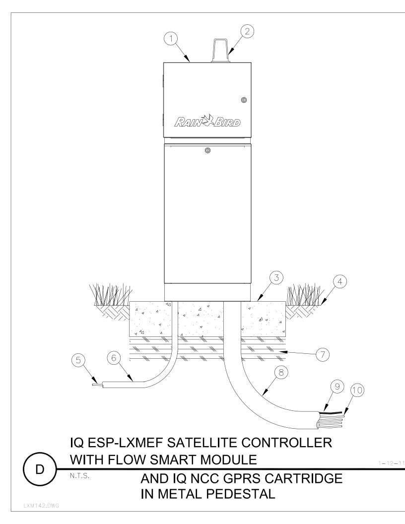
IRRIGATION CONTROLLER: RAIN BIRD IQ ESP-LXMEF SATELLITE CONTROLLER WITH FLOW
