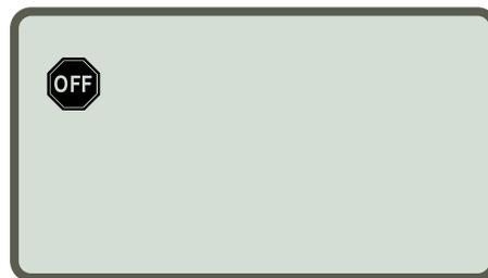
Los programas de riego permanecen almacenados en la memoria incluso cuando el controlador está apagado o si se ha perdido la corriente.
