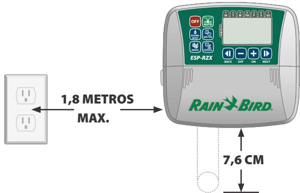
**!** **NOTA:** NO use una toma que esté controlada por un interruptor de luz con ENCENDIDO/APAGADO (ON/OFF) secundario o una toma con interruptor de falla de tierra.
