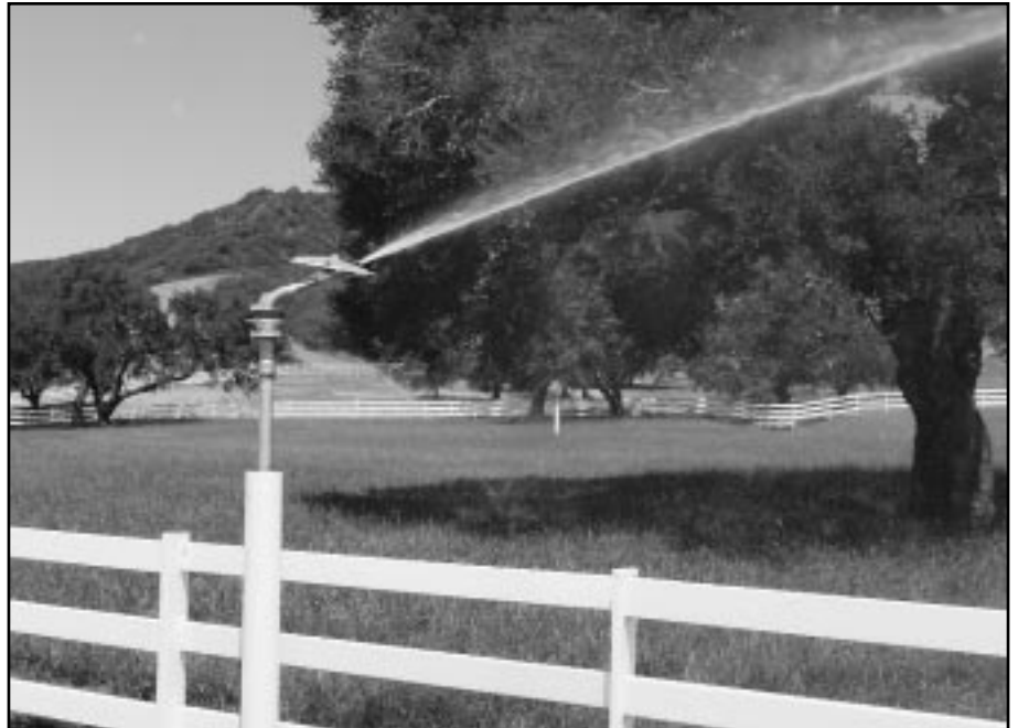
Controlando un cañon de aspersión de Rain Bird en un campo donde no hay cableado ni corriente eléctrica.
