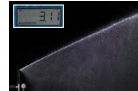
Aspersor 5000 PRS con boquilla de 3 gpm a una presión de entrada de 79 psi. Caudal regulado a 3,11 galones por minuto.
