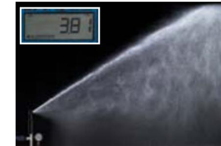
Rotor competitivo sin PRS con boquilla de 3 gpm a una presión de entrada de 79 psi. Sin PRS, el caudal aumentó a 3,81 galones por minuto.
