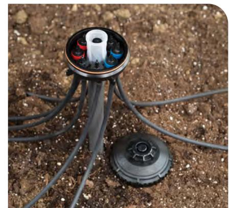
Cada puerto se puede configurar en Xeri-Bird™ con la instalación de emisores de caudal controlado. Arriba se muestra una combinación de emisores Xeri-Bug de 0.5; 1.0; y 2.0 gph.
