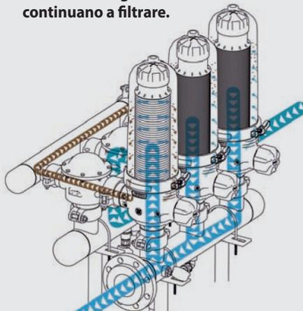
**FASE DI FILTRAZIONE:** Quando l'acqua attraversa i dischi, le particelle vengono proiettate via a causa dell'effetto ciclone, riducendo la frequenza di lavaggio a flusso invertito.
