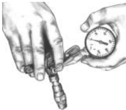
Gráfico 3 Se demuestra la introducción correcta del tubo piloto en la boquilla del aspersor. (Approx. 1/8" afuera de la abertura de la boquilla)
