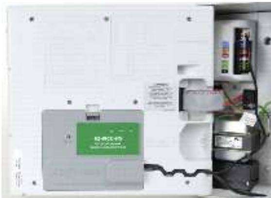
Cartucho de comunicación IQ (instalado)
