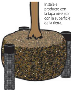
6. Instale la rejilla de forma que la superficie de la tapa quede debajo de las pestañas de cierre de la rejilla. Asegúrese de que las pestañas estén fijas sobre la rejilla.
