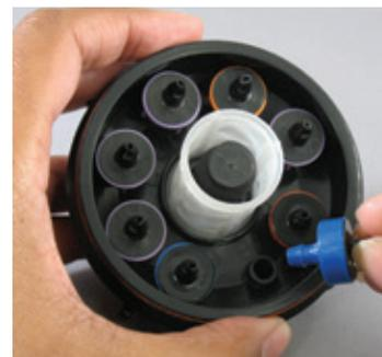
Consejo útil: siempre instale los emisores con el extremo en punta (conector de punta de entrada) o el extremo roscado hacia arriba, como se muestra
