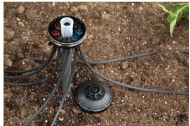
Cada puerto se puede configurar en Xeri-Bird™ con la instalación de emisores de caudal controlado. Arriba se muestra una combinación de emisores Xeri-Bug de 0.5, 1.0, y 2.0 gph.
